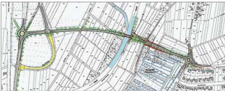
Die geplanten Kreisverkehre in der Verlängerung der Hohenkrähenstraße (links) und der Kreuzung Bruderhof-/Remishofstraße (rechts) sollen die Anchlusspunkte für die Nordstadtanbindung bilden. Die neue Straße liegt südlich der Einmündung des Saubaches in die Aach (siehe Mitte der Planskizze) und entlang der Nordseite des neuen Baugebietes Etzenfurth. Der jetzige Anschluss der Straße nach Hausen a.d. Aach (links/hellgrau) an die Hohenkrähenstraße kann dann rückgebaut werden.
